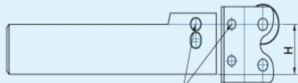
使用單輪刀片螺絲鎖緊的位置
