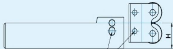
使用雙輪刀片螺絲鎖緊的位置
